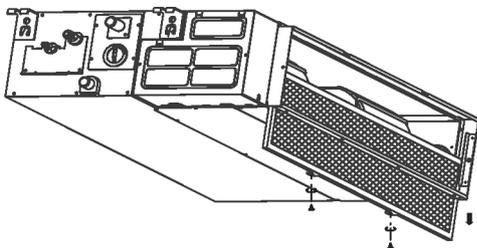
Se l'unità acquistata è dotata di ventilazione posteriore, estrarre il filtro nelle direzioni indicate dalle frecce nelle seguenti figure.
