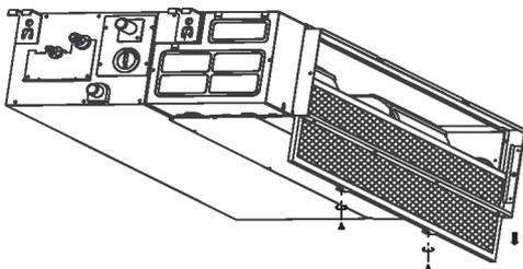
Hvis enheten du kjøpte er en med bakre ventilasjon, kan du ta av filteret i retningene som er angitt med piler i følgende illustrasjon.
