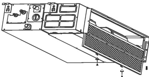
Wenn Sie eine Anlage mit Hinterlüftung gekauft haben, nehmen Sie den Filter heraus, indem Sie die von den Pfeilen in der folgenden Abbildung angezeigten Richtungen folgen.
