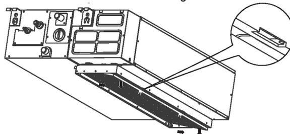
Se l'unità acquistata è dotata di ventilazione discendente, estrarre il filtro nelle direzioni indicate dalle frecce nelle seguenti figure.
