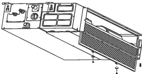
Se a unidade que adquiriu tiver ventilação traseira, retire o filtro nas direções indicadas pelas setas no esquema que se segue.
