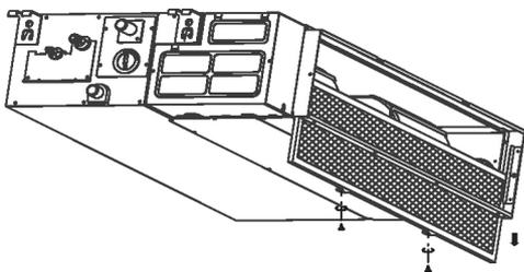
Jeśli posiadane urządzenie to wersja z nawiewem z tyłu, należy zdjąć filtr w kierunku wskazanym strzałkami na poniższym rysunku.
