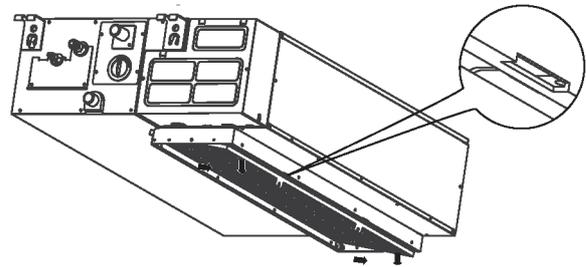
Om enheten du har köpt ventileras på undersidan tar du loss filtret i enlighet med pilarna på följande bild:
