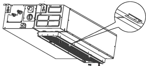
Kui teie ostetud seade on alla suunatud ventilatsiooniga mudel, eemaldage filter alljärgneval joonisel nooltega näidatud suunas.
