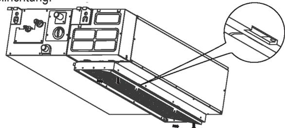
Wenn Sie eine Anlage mit rückläufigen Lüftung gekauft haben, nehmen Sie den Filter heraus, indem Sie die von den Pfeilen in der folgenden Abbildung angezeigten Richtungen folgen.
