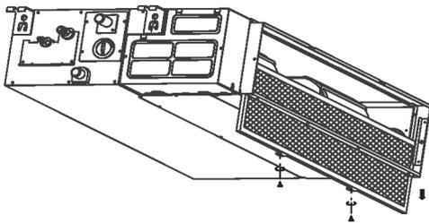
Om enheten du har köpt ventileras på baksidan tar du loss filtret enligt pilarna på följande bild:
