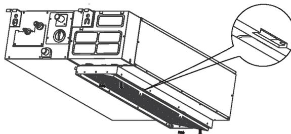
Hvis enheten du kjøpte er en modell med nedgående ventilasjon, kan du ta av filteret i retningene som er angitt med piler i følgende illustrasjon.
