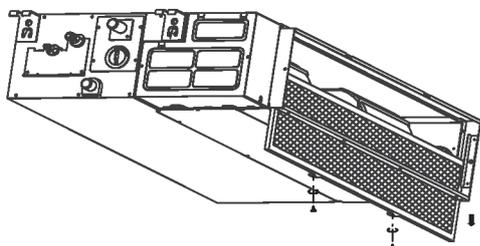
Si le climatiseur que vous avez acheté est un modèle à ventilation à l'arrière, retirez le filtre dans le sens des flèches, comme illustré ci-dessous.
