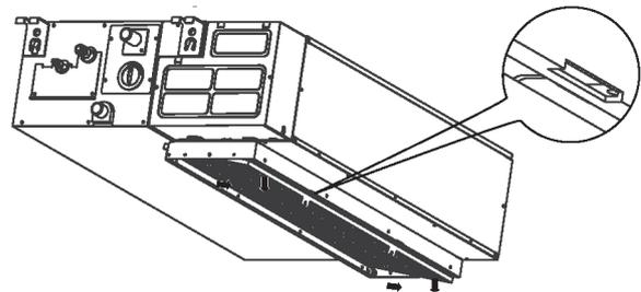
Se a unidade que adquiriu for um modelo com ventilação descensional, retire o filtro nas direções indicadas pelas setas no esquema que se segue.
