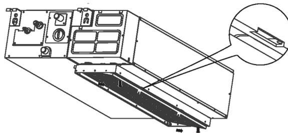
Jeśli posiadane urządzenie to wersja ze zstępującym prądem powietrza, należy zdjąć filtr w kierunku wskazanym strzałkami na poniższym rysunku.
