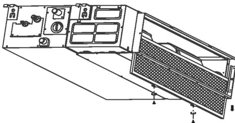
Kui teie ostetud seade on taha suunatud ventilatsiooniga, eemaldage filter alljärgneval joonisel nooltega näidatud suunas.
