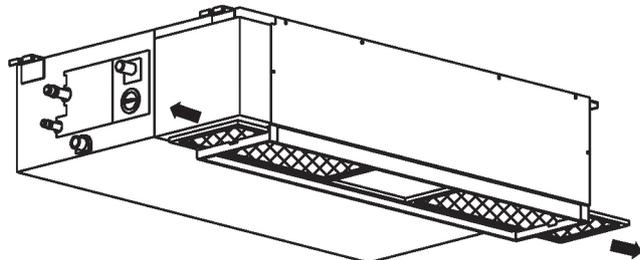
Reinigen Sie den Luftfilter.
